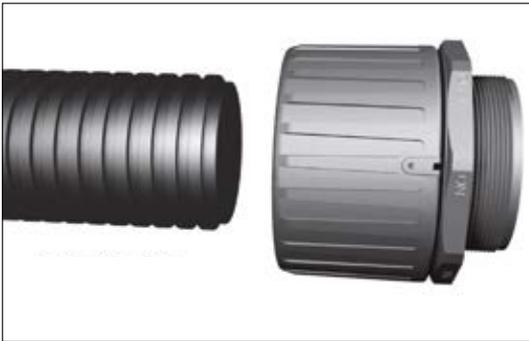
1. Achten Sie vor der Montage darauf, dass die Einkerbung des Verbindungsstcks auf die „On“-Position zeigt. Zum Befestigen der Verschraubungen drcken Sie das Schlauchende so weit wie mglich in die Verschraubung. Drehen Sie den Schlauch leicht, damit der Schlauch in die Verschraubung einrastet. Die Verschraubung ist sicher verriegelt.
