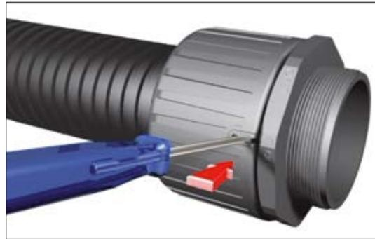
2. Zum Lsen der Verschraubung fhren Sie einen kleinen Schraubendreher in die Einkerbung des Verbindungsstcks ein.
