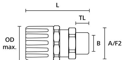
HelaGuard Verschraubung, gerade mit drehendem Außengewinde
