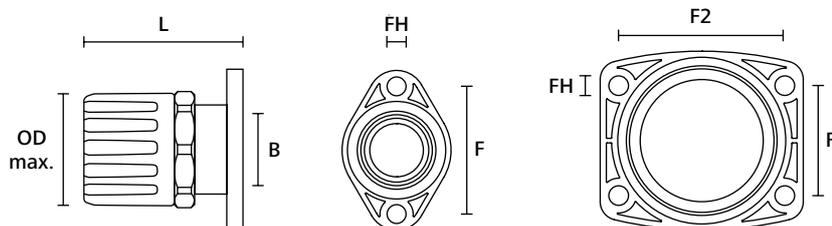
HelaGuard Verschraubung, gerade drehender Flansch
