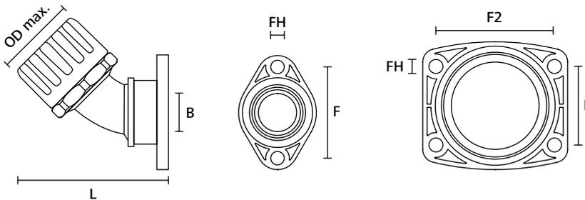
HeliaGuard Verschraubung, 45° drehender Flansch
