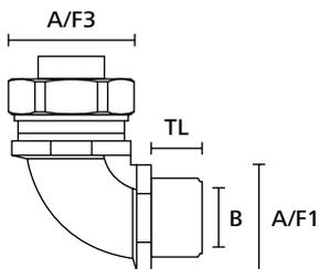
HeliaGuard Kompressionsverschraubung, 90° mit starrem Außengewinde
