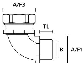
HelaGuard Kompressionsverschraubung, 90° mit starrem Außengewinde
