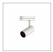
Spot 31 Slim, Richtstrahler, Lichtlenkung mit Reflektor, aus Aluminium, Entblendung mit Wabenraster, LED Bemessungslichtstrom: 2.200lm, Lichtfarbe: 930, Vorschaltgerät: EVG, mit 3-Phasen-Adapter, Netzanschluss: 220..240V, AC, 50/60Hz, Gehäuse, aus Aluminium, verkehrsweiß (RAL 9016), Durchmesser: 70mm, Adapter, aus Kunststoff, Schutzart (gesamt): IP20, Schutzklasse (gesamt): SK I (Schutzerdung), Prüfzeichen: CE,
