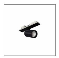
Licross® Spot 31, Richtstrahler, Lichtlenkung mit Linse, aus Kunststoff, LED Bemessungslichtstrom: 3.680lm, Lichtfarbe: 940, Vorschaltgerät: EVG-DALI, mit Stecker, 5polig, Netzanschluss: 220..240V, AC, 50/60Hz, aus Aluminium, tiefschwarz (RAL 9005), Länge: 140mm, Durchmesser: 90mm, Schutzart (gesamt): IP20, Schutzklasse (gesamt): SK I (Schutzerdung), Prüfzeichen: CE, Verpackungseinheit: 1 Stück
