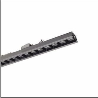
Licross® 21 Silica, Leuchteneinsatz, aus Stahlblech, verzinkt, bandlackiert, silber, Länge: 1.500mm, Breite: 82mm, Höhe: 86mm, LED
