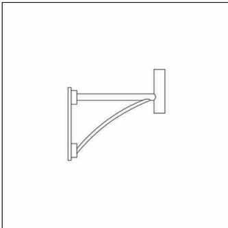
Schwinge, Wandausleger, Designausleger, aus Stahl, verzinkt und lackiert, Siteco® eisenglimmer (DB 702S), 1armig, Breite: 100mm, Höhe: 500mm, Auslegermaß: 600mm, Verpackungseinheit: 1 Stück
