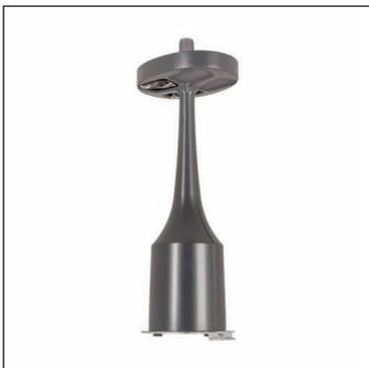
Baugruppe Elektrik, für Modul 540 iQ, Geräte-Träger, Vorschaltgerät: EVG iQ, LED Lichtstrom: 1.530 lm, Farbtemperatur: 3000K, mit Klemme, 6polig, max. 2,5mm<sup>2</sup>, Netzanschluss: 230..240V, AC, 50/60Hz, Beginn der Lebensdauer: 11 W, Ende der Lebensdauer: 11 W, Reduzierung: 5 W, primäre Lichtcharakteristik: asymmetrisch, Breite: 190 mm, Höhe: 514mm, Schutzklasse (gesamt): SK II (Schutzisoliert), Prüfzeichen: CE, ENEC, VDE
