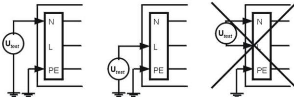
Nach abgeschlossener Isolationsprüfung ist die einwandfreie Leiterverbindung zwischen Netz und Beleuchtungsanlage wieder herzustellen. Vor Inbetriebnahme ist der feste Anschluss des Neutralleiters sicherzustellen, um das Vorschaltgerät durch unzulässige Überspannung bei unsymmetrischer Netzbelastung nicht zu beschädigen (siehe hierzu Abschnitt 5.2).
