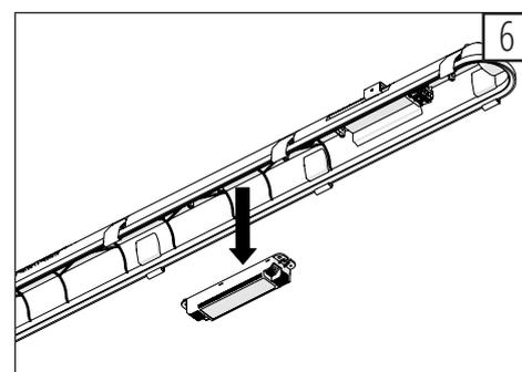
Die Leuchte kann nun in umgekehrter Reihenfolge wieder zusammengebaut und montiert werden. Achten Sie dabei auf den korrekten Sitz der Dichtungen und prüfen sie auf eventuelle Beschädigung.
