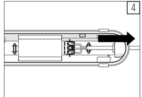
Der LED-Träger kann nun durch vorsichtiges Aufbiegen mit einem Schraubenzieher oder anderem geeigneten Werkzeug an den rückseitigen Rastnasen der Abdeckung entfernt werden. (5,6)
