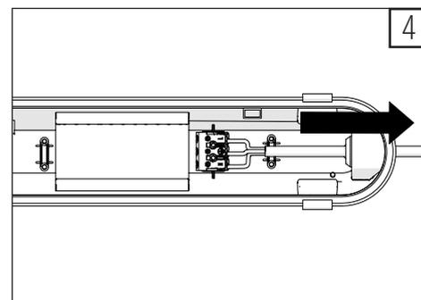
Das Vorschaltgerät kann nun durch lösen der Anschlussleitungen und der Befestigungsschrauben getauscht werden.(5,6)
