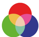
Mischfarben werden mit der Ansteuerung mehrerer Eingänge gleichzeitig erreicht. / Mixed colours will be achieved with the control of multiple inputs simultaneously.
