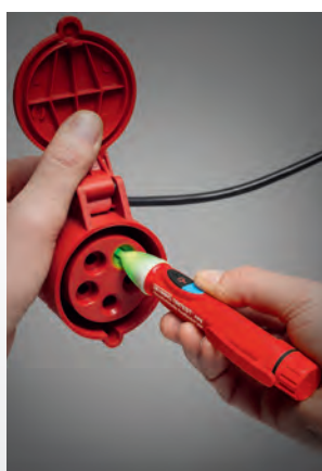
Test d'ordre de phases vert = rotatif „à droite“
