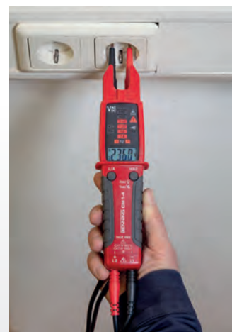
Mesure de tension d'une seule main
