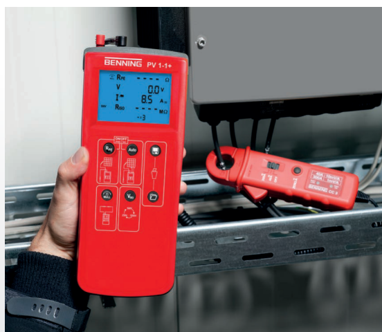
DC-Betriebsstrommessung mit BENNING CC 3
