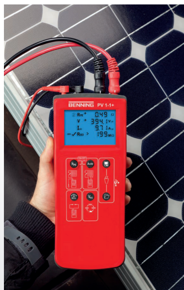
Automessung am PV-Strang (Uoc, Isc, Riso)
