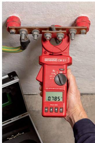
Messung des Erdschleifenwiderstandes eines Anlagenerders
