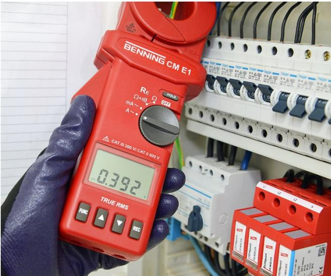
Messung des Gesamt-Ableitstroms in einer Unterverteilung.
