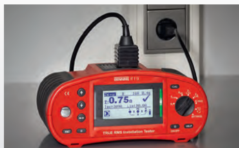
IT 115 bei der Schleifenimpedanzmessung ohne RCD-Auslösung
