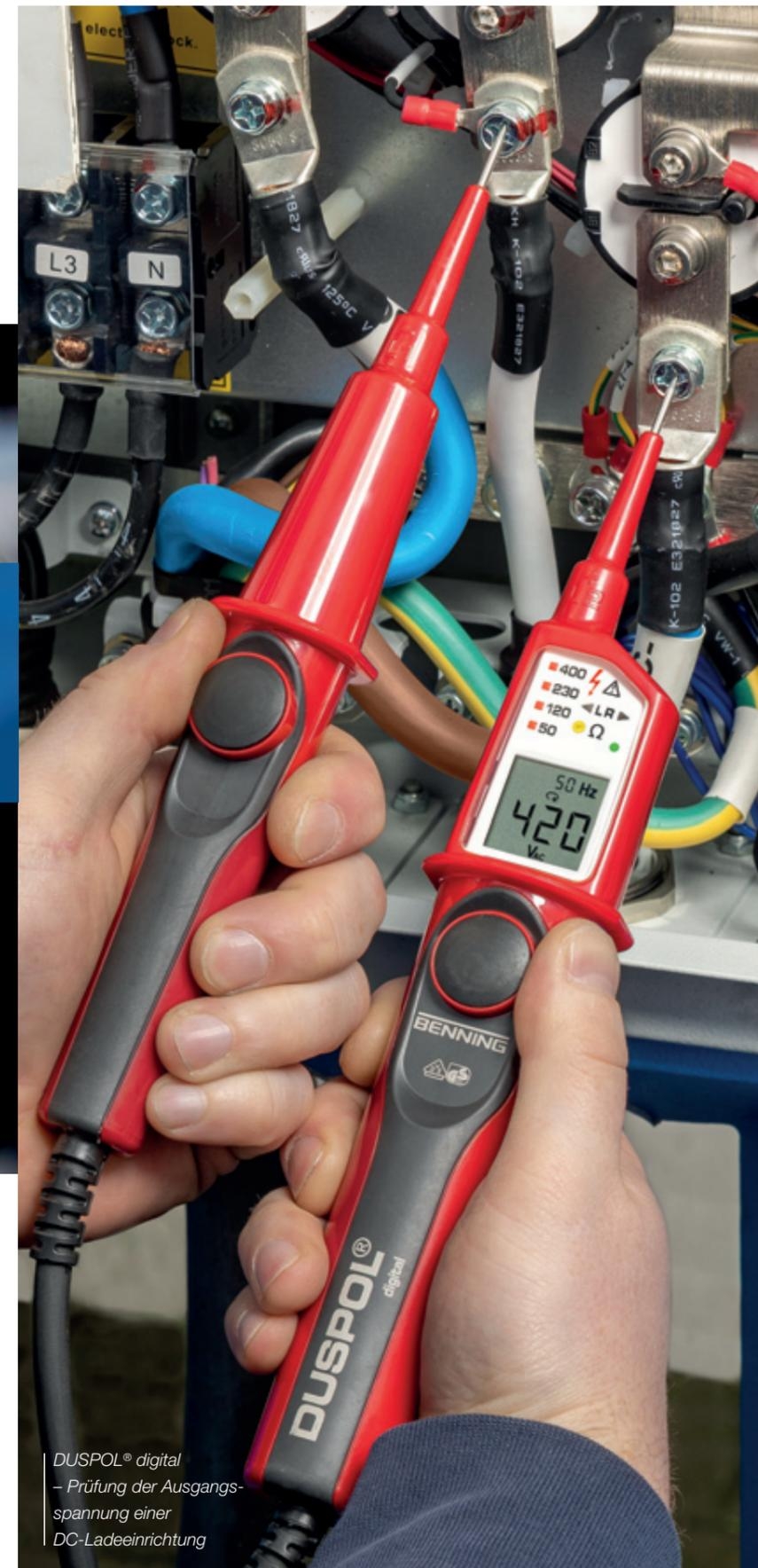
DUSPOL® digital – Prüfung der Ausgangsspannung einer DC-Ladeeinrichtung
