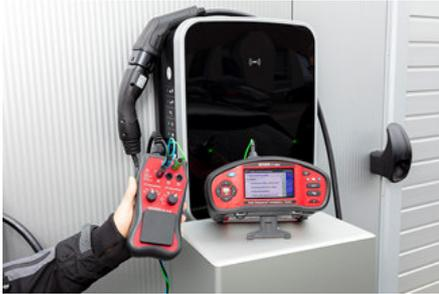
Speziell für die Prüfung von EV-Ladestationen (Mode 3) abgestimmte Auto Sequences®, für 1- und 3-phasige Wallboxen inkl. Funktionsprüfung und Erprobung des Ladevorgangs, sind über den Prüfadapter BENNING EV 3-2 möglich. Dabei wird die Prüfung von EV-RCD und 6 mA DC Fehlergleichstrom-Überwachungs-Einrichtungen (RDC-DD) gemäß IEC 62955 mit Messung der Auslösezeit und des Auslösestromes unterstützt.
