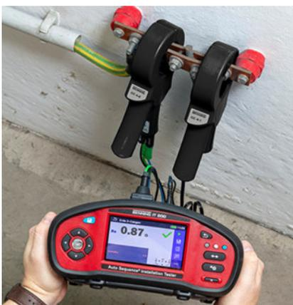
Die Messung von Spannung (TRUE RMS) und Frequenz und Bestimmung der Phasenfolge schließen die Messungen der VDE-Sicherheitsprüfung ab.
