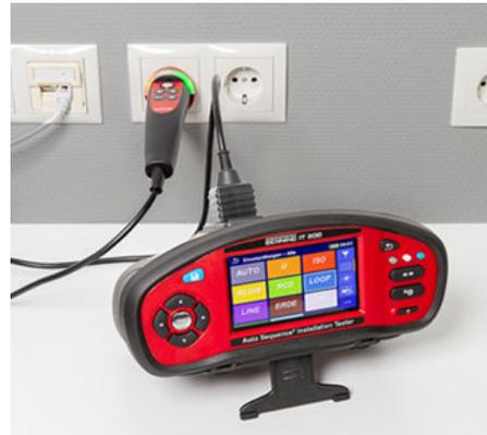
Es wird eine breite Palette von Funktionen angeboten, angefangen von der Online-Spannungsüberwachung, über die Schutzleiter- und Durchgangsprüfung, Isolationswiderstandsmessung, Leitungs- und Schleifenimpedanz Messungen, Prüfungen vieler Typen von Fehlerstromschutzeinrichtungen, ISFL-Messungen in IT-System bis hin zur Leistungs- und Oberwellenmessungen (THD).
