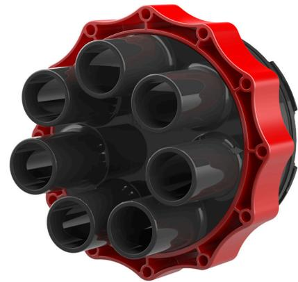
Zum Einsatz in Dichtpackung und Kunststoffflansch HSI150. Die Thermomuffen bieten einen großen Anwendungsbereich und werden unter Hitzeeinwirkung vom Systemdeckelstutzen auf die Kabel geschrumpft. Unbelegte Systemdeckelstutzen können mit Verschlussstopfen verschlossen werden.
