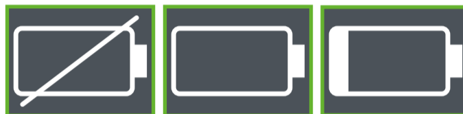
11. Batterie nicht bestückt 12. Batterie erschöpft 13. batterie schwach
