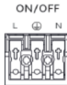
Abb.: 4 Anschlusschema: Dali oder schaltbar
