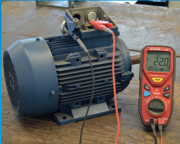
Messung des Isolationswiderstandes mit 1000 V
