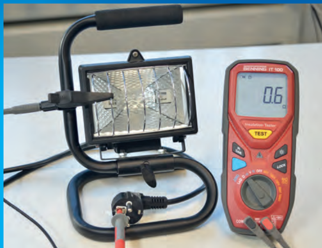
Widerstandsmessung zur Prüfung des Schutzleiters
