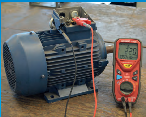
Messung des Isolationswiderstandes mit 1000 V
