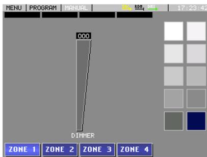
**DIMMER:** Der DIMMER Modus belegt nur einen Kanal. Der Helligkeitswert kann mit dem Fader eingestellt werden.
