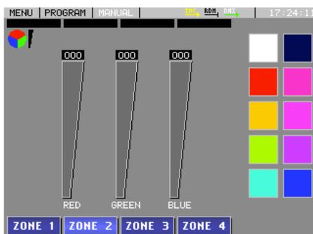
Im Fadermodus können Sie jeden Kanalwert der RGB Grundfarben Rot, Grün und Blau über einen separaten Fader einstellen. Über das RGB Symbol in der linken oberen Ecke des Bildschirms können Sie zwischen Palettenmodus und Fadermodus umschalten.
