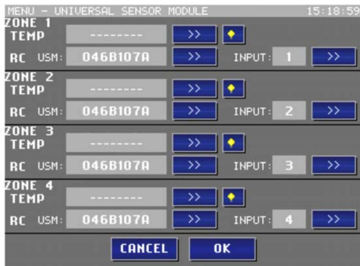
Zwei verschiedene Funktionen können in diesem Menü programmiert werden: ein Temperatursensor und eine Fernbedienung.
