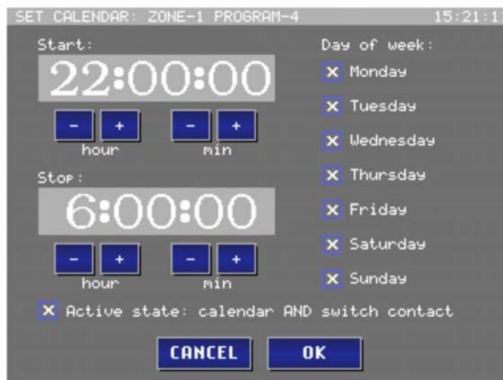
Die Kalenderfunktion kann mit der Kontaktfunktion des USM Moduls kombiniert werden. Dies bedeutet, dass das Programm nur gestartet wird, wenn Uhrzeit und Datum mit der im Kalender programmierten Start-Stop Zeit übereinstimmt und zusätzlich der selektierte Kontaktsensor aktiviert (geschlossen) wird.
