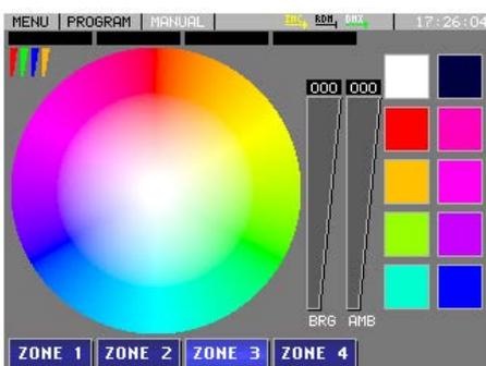
**RGBA oder RGBW:** Der RGBA oder RGBW Modus benötigt vier Kanäle. Im Palettenmodus können Sie eine Farbe direkt über die RGB Palette auswählen. Jede Farbe in der Palette besteht aus allen drei Grundfarben (ROT, GRÜN, BLAU) sowie einer weiteren Farbe (BERNSTEIN oder WEISS). Mit dem BRIGHTNESS Fader können Sie die gewünschte Helligkeit der Farbe von 0% bis 100% einstellen.
