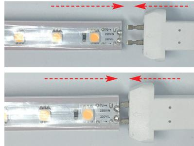
**Wichtig:** Die Kontaktierung muss zwingend von unten vorgenommen werden, da eine Kontaktierung von der Oberseite der Platine zur Beschädigung des Lichtbandes führt.
