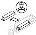
LED-Betriebsgerät austauschbar durch Elektrofachkraft
