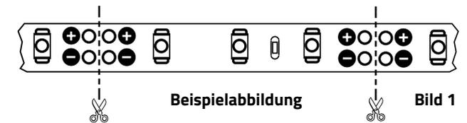
**VARDAFLEX** LED-Strip an der markierten Stelle trennen. Bei eng bestückten LED-Strips wird ein Mikroseiten-schneider oder optional ein Cutter benötigt!
