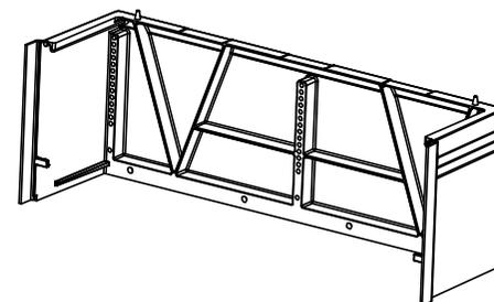
**Bodenaufbausockel für Gehäuse 88S1700 und 88S2000**
