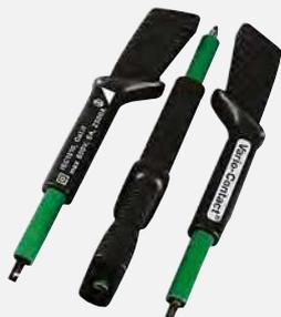
Drei selbthaltende Prüfspitzen mit Berührungsschutz zum Anschluss von Messleitungen mit 4 mm-Bananensteckern bzw. mit berührungsgeschützten Steckern an Buchsen mit Öffnungen von 3,5 mm bis 12 mm, z. B. CEE-, Perilex-Steckdosen.
