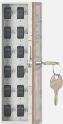
Fehlersimulator mit 12 Fehlermöglichkeiten über Schalter
