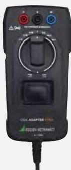
METRAHIT IM XTRA und METRAHIT IM E-DRIVE ermöglichen in Verbindung mit dem optionalen COIL TEST ADAPTER Windungsschlussmessungen an Elektromotoren und -generatoren. Der Adapter Z270M ist universell für viele Elektromaschinen unterschiedlicher Leistungsklassen geeignet. Für DIN-Norm-Motoren entspricht dies Leistungen von ca. 160 VA bis ca. 80 MVA.
