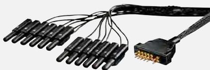
Adapterkabel für SECUTEST, SECULIFE ST zur Adaption der 2 mm Anschlussbuchse an SECUTEST / SECULIFE ST auf 4 mm Buchsen und Stecker, 1,5 m lang mit 12 Leitungen jeweils mit 4 mm Stecker
