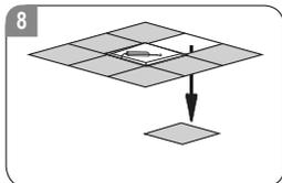
Entfernen Sie ein Deckenpaneel neben dem LED-Panel.
