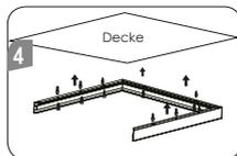
Rahmens, entnehmen Sie eine Seite des zuvor zusammengebauten Rahmens und verschrauben Sie den Rest an der Decke. Schließen Sie das LED-Netzgerät an das Stromnetz an und legen Sie dieses auf das Panel. Schieben Sie das Panel nun in den Rahmen ein und stecken Sie das entnommene Teil des Rahmens wieder auf. Versorgungsnetz freischalten und Funktionstest.
