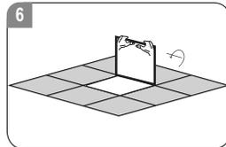
Platzieren Sie das LED-Panel in einer Linie mit dem Deckenraster.
