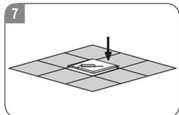
Stellen Sie sicher, dass die Platte gleichmäßig innerhalb des T-Bar-Deckengitters sitzt.
