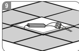
Schließen Sie den LED-Netzgerät an das Stromnetz an. Setzen Sie das Deckenpaneel wieder ein, um die Installation abzuschließen.
