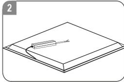
Platzieren Sie das Netzgerät auf der Rückseite des Panels.
