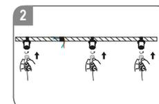
Schrauben Sie das Aufhangekabel an die Deckenbefestigung.
