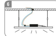
Schließen Sie den LED-Netzgerat an das Stromnetz an.
