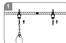
Stecken Sie die Dubel in die Decke und befestigen Sie die Aufhangeflachenbefestigung an der Decke.
