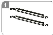
Hauptschalter für den betroffenen Bereich ausschalten. Stecken Sie den Rahmen vollständig zusammen, um bei der Anfertigung der Bohrlocher Verformungen vorzubeugen. Halten Sie den Anbaurahmen an den dafür vorgesehenen Platz und Zeichnen Sie die Löcher für die Bohrungen an drei Seiten an. Die vierte Seite muss nicht angezeichnet und gebohrt werden, diese wird später aufgesteckt. Fertigen Sie nun die Löcher für den Anbaurahmen an drei Seiten an. Zum einlegen des Panels und zur Befestigung des
