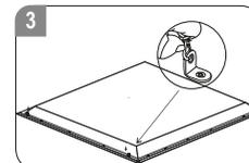
Verriegeln Sie das Aufhangekabel am LED-Panel.
