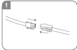
Verbinden Sie das LED-Panel Kabel mit dem LED-Netzgerät.
