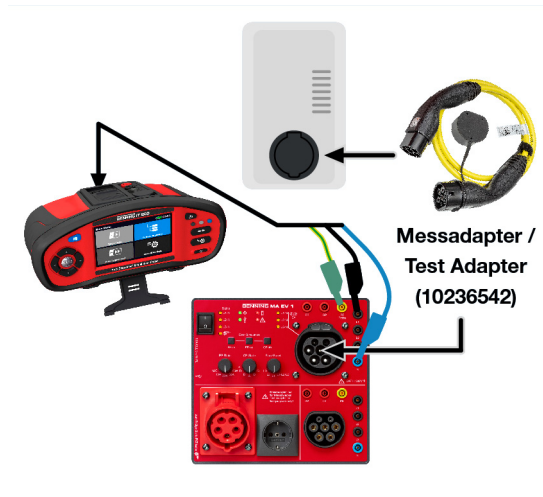
Abb. 9: Anschlusschema AC-Ladestations-Prüfung mit optionalem Messadapter
