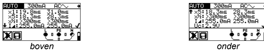
Afbeelding 5.22: De toets HELP schakelt heen en weer tussen het bovenste en onderste deel van het resultaatveld.
