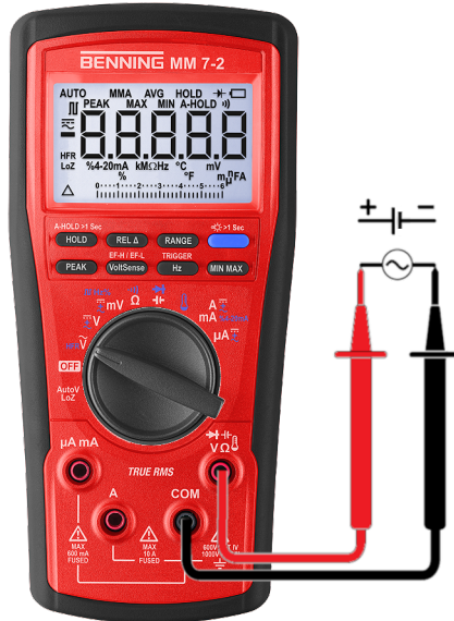
Illustration 9: Spændings-, frekvens- eller tastforholdsmåling
