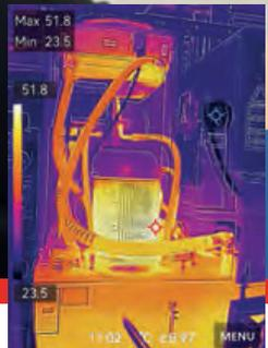
Thermografische Sichtprüfung von Motor und Druckschläuchen einer Blechstanze ohne Betriebsunterbrechung
