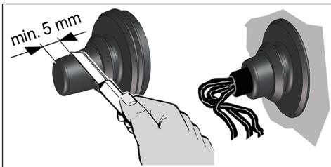
7. Leitungsstüle in Gehäuse einsetzen.
