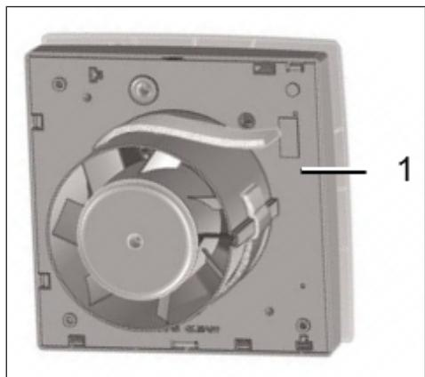
6. Beigefügtes Schaumstoffband am Stutzen mittig anbringen.
