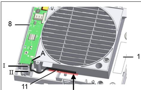
10. Gehäuse in Wanddurchbruch/Wandhülse einsetzen und mit zwei Schrauben befestigen. Gehäuse weder verspannt noch gequetscht einsetzen. Ausreichend dimensioniertes Befestigungsmaterial verwenden.
