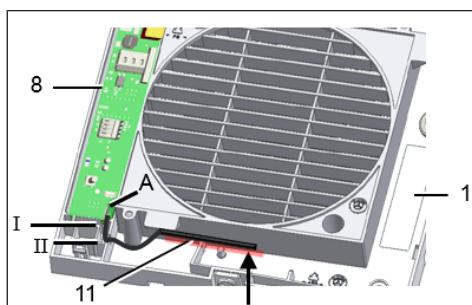
10. Placer le boîtier dans le perçage de cloison / la gaine murale et le fixer avec deux vis. Installer le boîtier sans tension ni écrasement. Utiliser du matériel de fixation de dimension suffisante.
