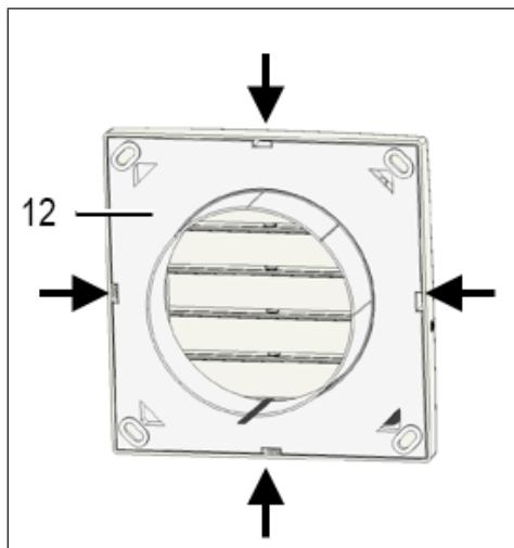
1. Außenverschlussklappe mit Außen-Kombisensor auspacken und Außenstück abnehmen. Zum Lösen des Außenstücks Rasthaken (→ Pfeil) mit Schraubendreher entriegeln.
