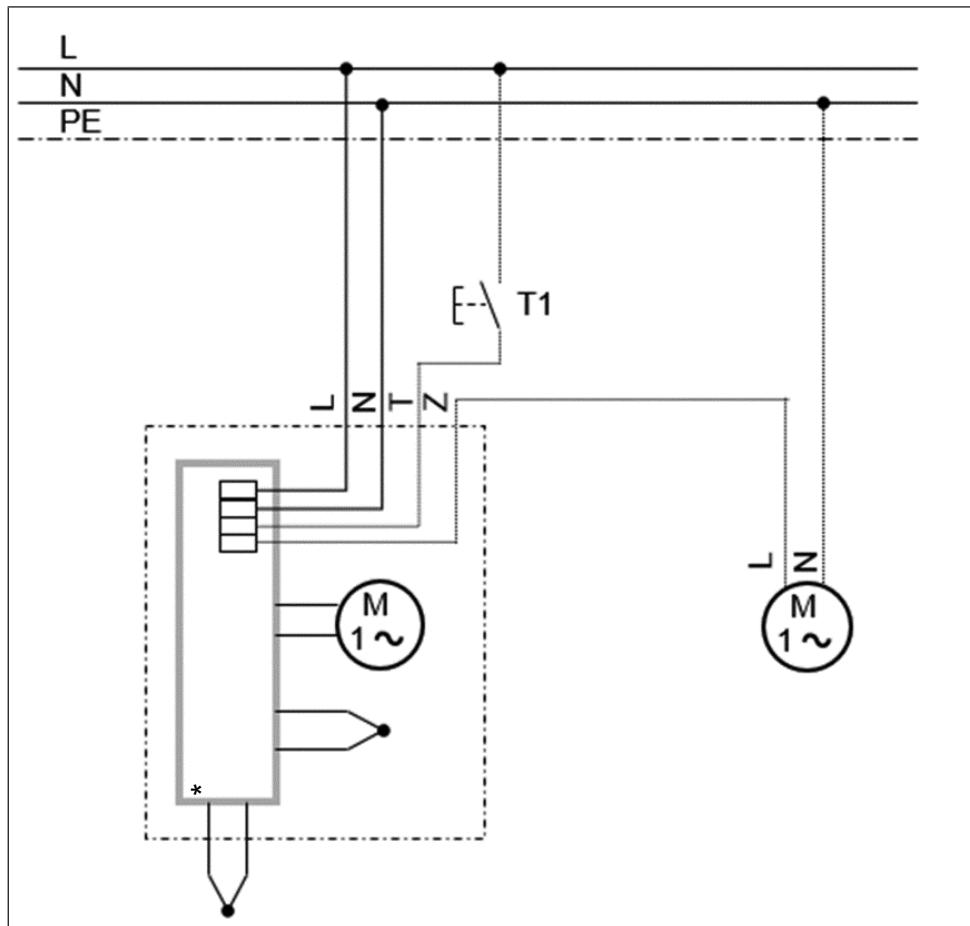
\* Entfeuchtungssteuerung / Dehumidification control / Commande de déshumidification
