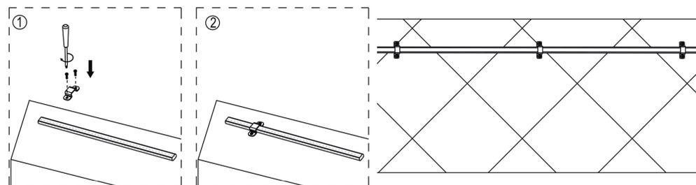
Zur dauerhaften Befestigung verwenden Sie geeignete Schellen oder Halter. Benutzen Sie keinen dünnen Draht oder Ähnliches zum Befestigen, der könnte die Kunststoffbeschichtung beschädigen. Bei längerer bzw. dauerhafter Installation muss der LED-Stripe schwingungsfrei befestigt werden, um Leitungsbrüche zu verhindern.
