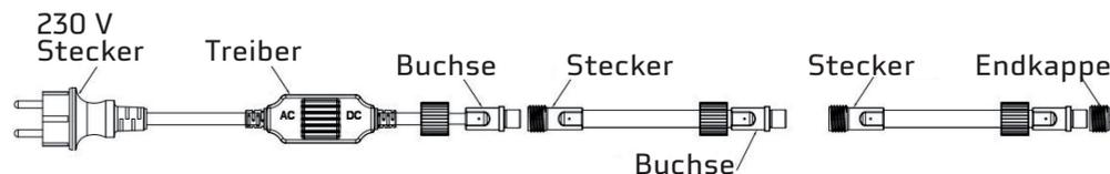
Zur Erweiterung des LED-Stripes stecken Sie die Stecker und Buchsen zusammen. Achten Sie bitte darauf dass die Überwurfmutter und die Endkappe korrekt und fest verschraubt sind!
