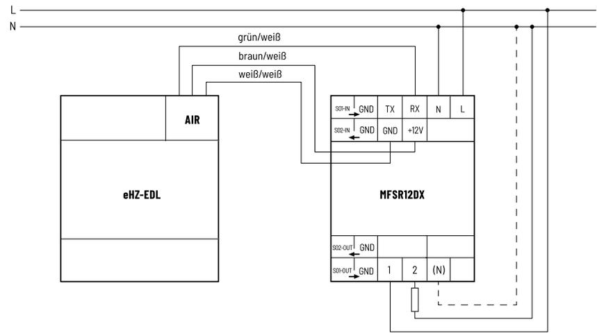
Bei angeschlossenem (N) ist die Kontaktschaltung im Nulldurchgang aktiv.
