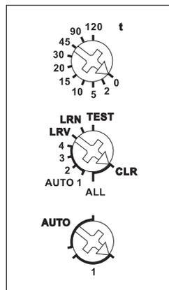
Mit den Drehschaltern werden die Taster eingelernt und gegebenenfalls das Gerät getestet. Für den Normalbetrieb werden der mittlere und der untere Drehschalter anschließend auf AUTO gestellt. Bei dem oberen Drehschalter wird ggf. die EW-Zeit (0-120 Sekunden) für Relais bzw. die RV-Zeit (0-120 Minuten) für Stromstoßschalter eingestellt.
