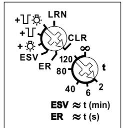
**Mit dem oberen Dreheswitch** werden in der Stellung LRN bis zu 35 Funktaster zugeordnet, davon ein oder mehrere Zentralsteuerungs-Taster. Außerdem Funk-Fenster-Türkontakte mit der Funktion Schließer oder Öffner bei geöffnetem Fenster. Danach wird damit die gewünschte Funktion dieses Stromstoß-Schaltrelais gewählt:
