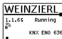
Die Repeater-Funktion des KNX ENO 636 wird über die allgemeinen Parameter in der ETS aktiviert. Ist die Funktion aktiv, wird dies im Hauptmenü des Displays links unter der individuellen Adresse angezeigt.
