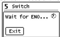
Sensor eingelernt. Fenstergriffe und Schaltmodule müssen zum Einlernen betätigt werden, da sie keine Lerntaste besitzen.
