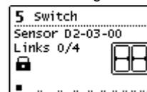
Die Anzahl der benutzten und verfügbaren Kanallinks wird in der dritten Zeile angezeigt. Ist bei einem Kanal Verschlüsselung aktiviert, wird das in der nächsten Zeile mit einem Schloss dargestellt. In der letzten Zeile ist der Signalstärke-Balken sichtbar.
