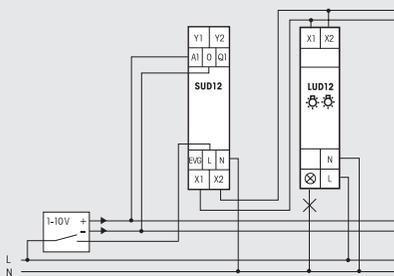
In dieser Schaltungsart kann, in Verbindung mit einem an die Anschlüsse X1/X2 angeschlossenen Leistungszusatz LUD12, der Ausgang eines 1-10V-Steuergerätes an A1/0 in eine direkte Dimmfunktion umgesetzt werden. Das Ein- und Ausschalten erfolgt ebenfalls extern an L des SUD12.
