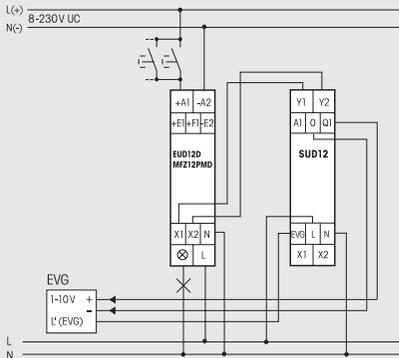
In dieser Schaltungsart können, in Verbindung mit einem Universal-Dimmschalter EUD12D bzw. MFZ12PMD, elektronische Vorschaltgeräte und Trafos mit einer 1-10V-Schnittstelle bis zu 40mA Gesamt-Steuerstrom angesteuert werden.
