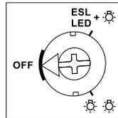
Die Schaltungsart 'eine Leuchte' (☀️) oder 'zusätzliche Leuchten' (☀️☀️) wird mit einem Drehschalter auf der Frontseite eingestellt.
