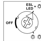
Diese Einstellung muss bei ESL und 230 V-LED-Lampen auf der Frontseite eingestellt werden, wenn der Universal-Dimmschalter in den Comfort-Einstellungen ESL oder LED betrieben wird. Auch bei Leistungserhöhung mit zusätzlichen Leuchten. **Sonst könnte die Elektronik zerstört werden!**
