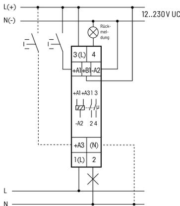
Bei angeschlossenem N ist die Kontaktschaltung im Nulldurchgang aktiv.
