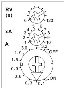
Die Strombasis A wird mit dem unteren rastenden Drehschalter A eingestellt.
