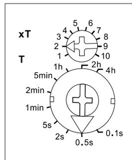
**Die Leuchtdiode** unter dem großen Drehschalter informiert während des Zeitablaufes über die Kontaktstellung. Sie blinkt, solange der Arbeitskontakt 15-18 offen ist (15-16 geschlossen) und leuchtet ständig, solange der Arbeitskontakt 15-18 geschlossen (15-16 offen) ist.
