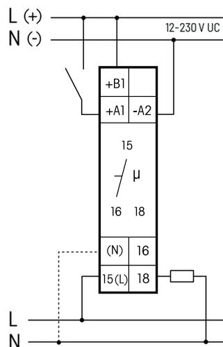
Bei angeschlossenem N ist die Kontaktschaltung im Nulldurchgang aktiv.
