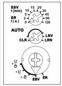
Mit dem unteren Drehschalter wird die Funktion des Aktors eingestellt.
